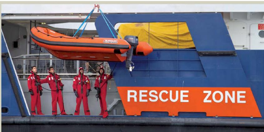
Bateaux auxiliaires professionnels forts et robustes, à grande capacité de charge et stabilité grâce au diamètre de ses flotteurs. Pour le service et comme auxiliaire de bateaux professionnels de plus grande taille ayant un espace d'arrimage réduit. Flotteurs avec des renforts antidérapants sur les zones qui souffrent plus de frottement, des soupapes de surpression, bâillon de manœuvre, anneaux de mouillage renforcés qui permettent de fixer un jockey, dispositif de contrôle à distance.
