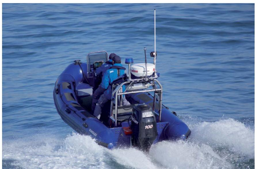
Il est très marin, avec un « V » très marqué sur la proue, large pont auto-vidueur de 6,35 m<sup>2</sup>, avec une grande soute de proue stable qui permet l'ancrage d'équipements et l'accès par la proue à d'autres bateaux. Il a des flotteurs levés sur la ligne de flottaison qui améliorent ses performances de navigation et qui empêchent la génération d'algues et d'incrustations pendant les longues périodes de mouillages.
